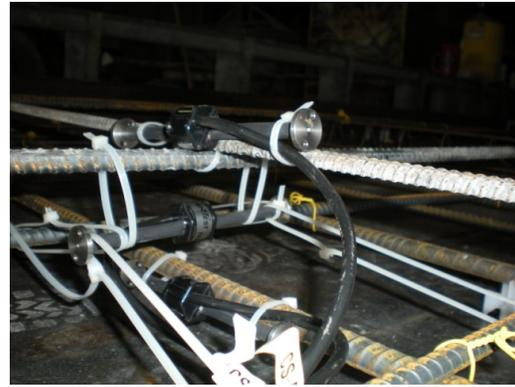
b.) HS-SCC Mild Steel VWSG Arrangement
